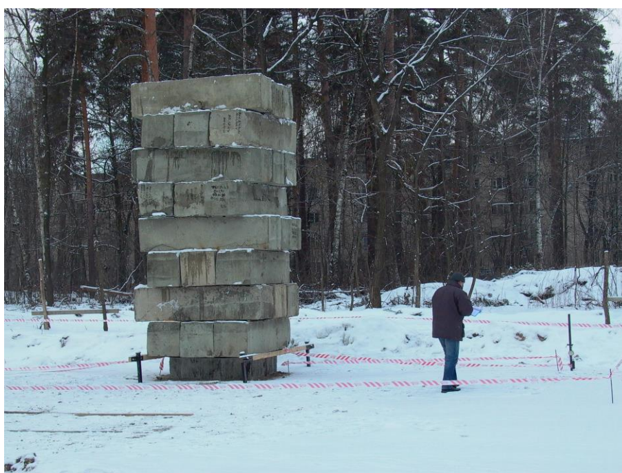
Рис. 8. Испытания грунта штампом площадью 25000 см 2
