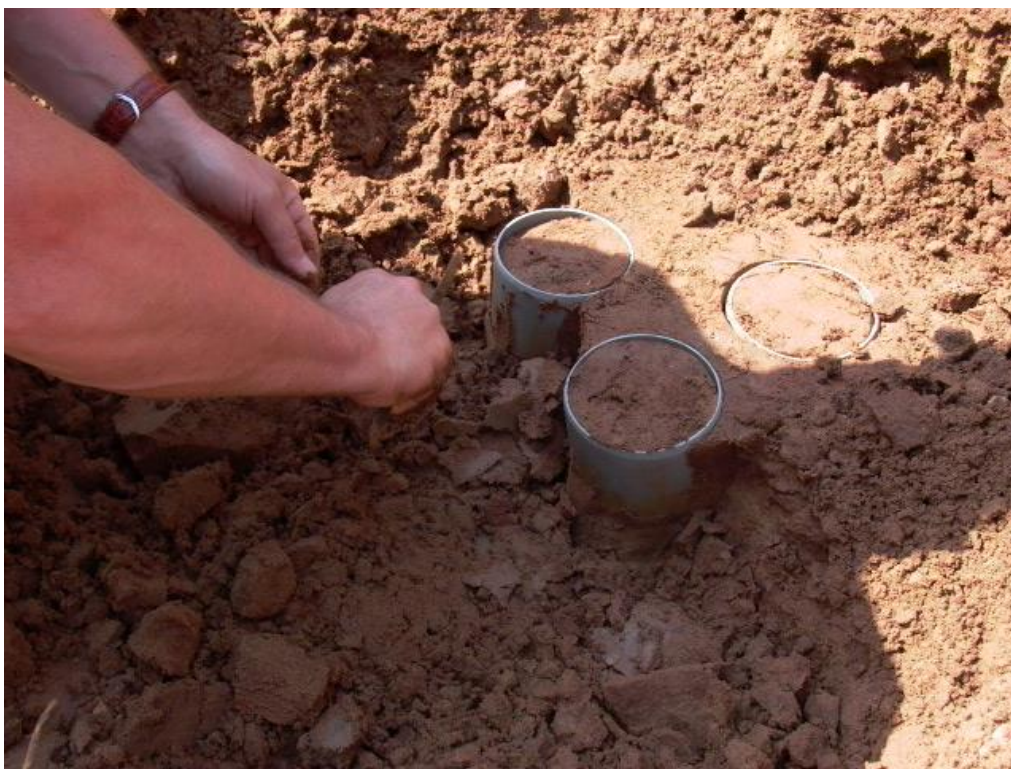
Рис. 4. Отбор монолитов супеси. Штамп номер 3.
