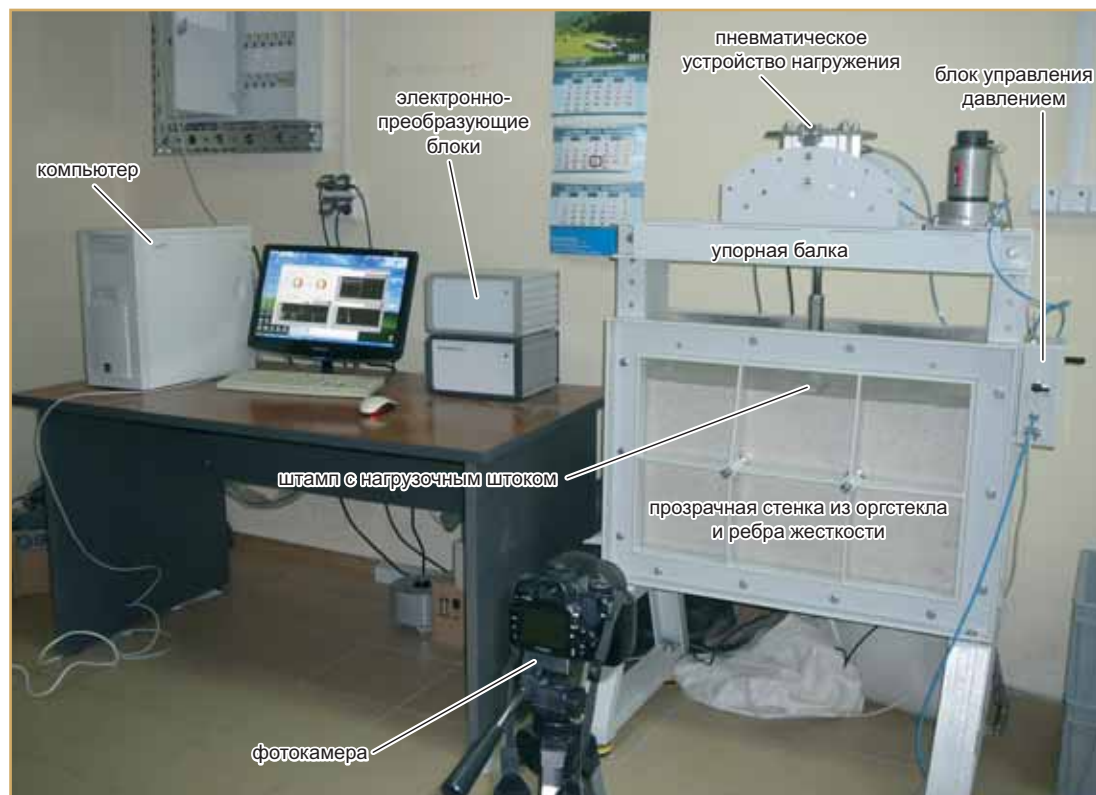
Рис. 4. Автоматизированный стенд для испытаний моделей фундаментов
