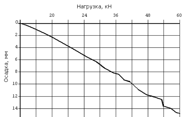
Рис. 2. Результаты решения методом Лагранжа: а – контуры пластических деформаций; б – зависимость осадки центра штампа от нагрузки;
