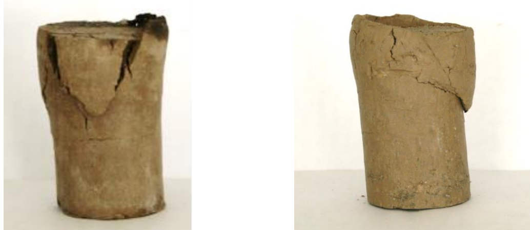
Рис. 2. Форма деформации при смазанных концевиках
