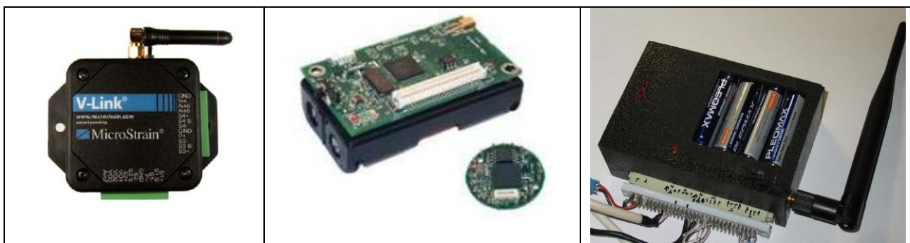
Рис. 5. Общий вид сенсорного узла различных фирм: а – Microstrain /8/; б – Crosbow /9/; в – ООО «Геотек» /10/
