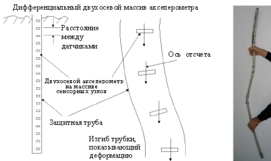
Рис. 2. Схема расположения акселерометров MEMS и внешний вид нескольких звеньев инклинометра (Zeghal, /3/)
