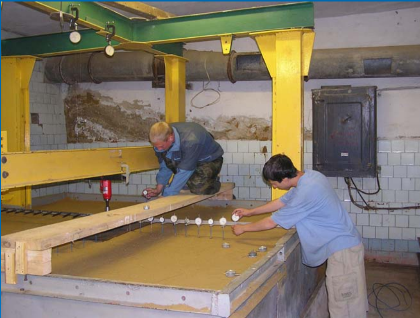
Измерение осадки штампа и деформации поверхности песчаного основания
