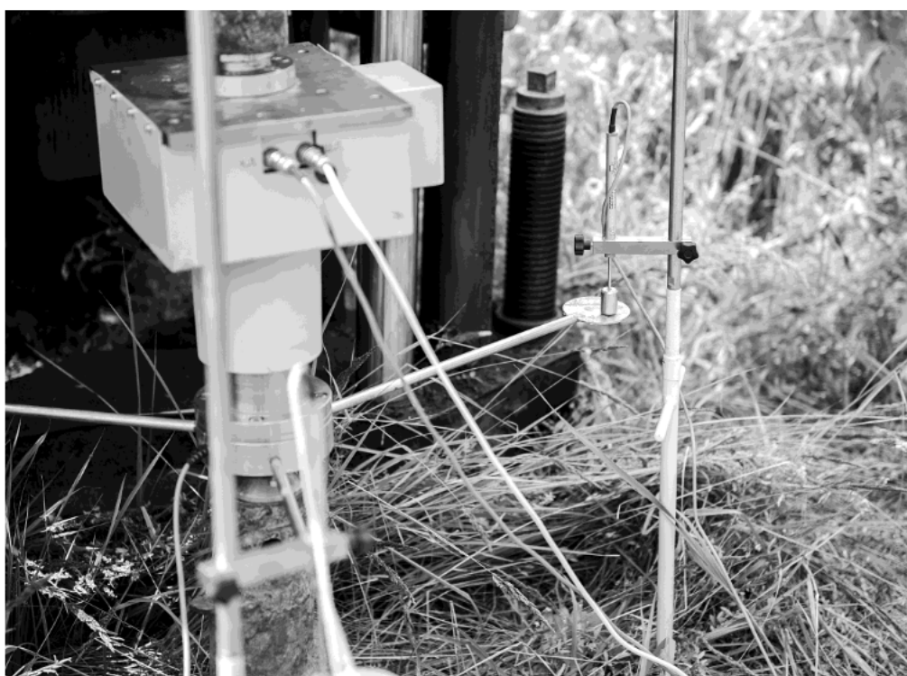
Рис. 10.8. Измерение осадки шнека датчиками перемещений
