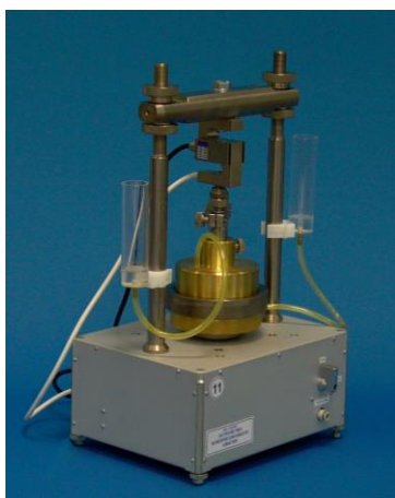
Рис. 1. Приборы для испытания образцов грунта, конструкции ООО «Геотек»: а – компрессионный прибор; б – прибор трехосного сжатия (стабилометр)
