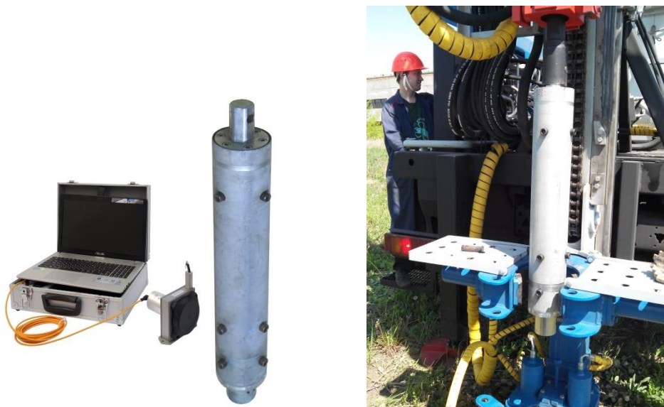
а – комплект для испытаний методом бурового зондирования; б – подготовка к работе устройства бурового зондирования
