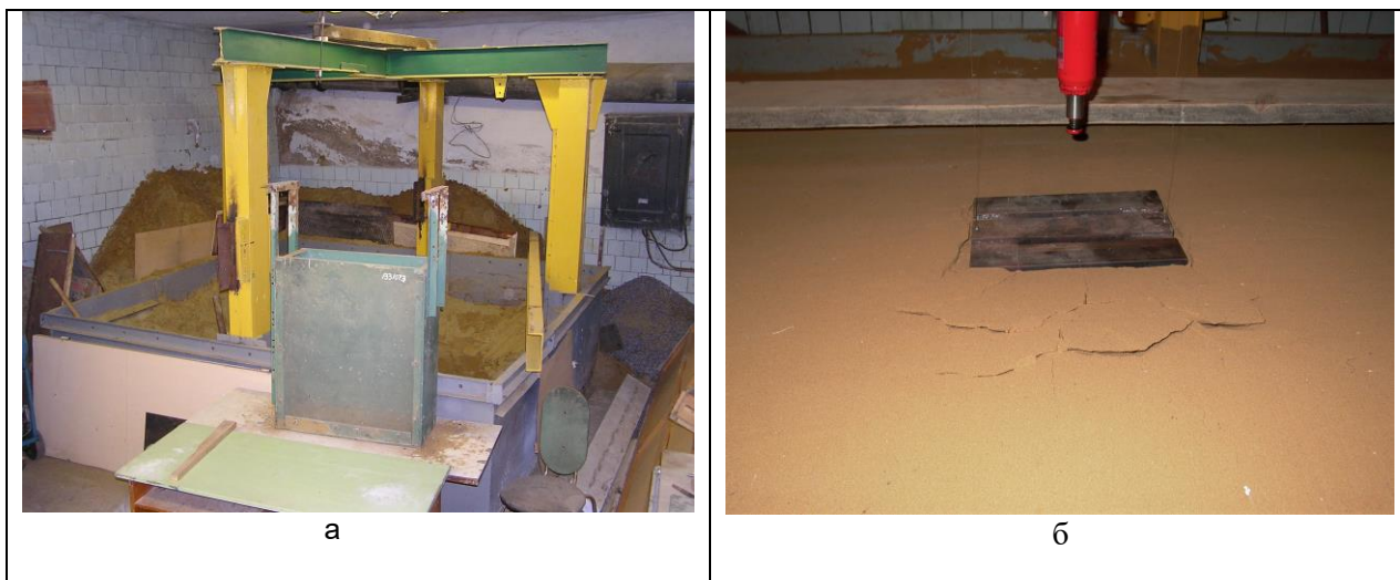
Рис. 13. Испытания в условиях пространственной деформации: а – испытательный стенд; б – деформация поверхности песчаного основания. Модель 30x40 см
