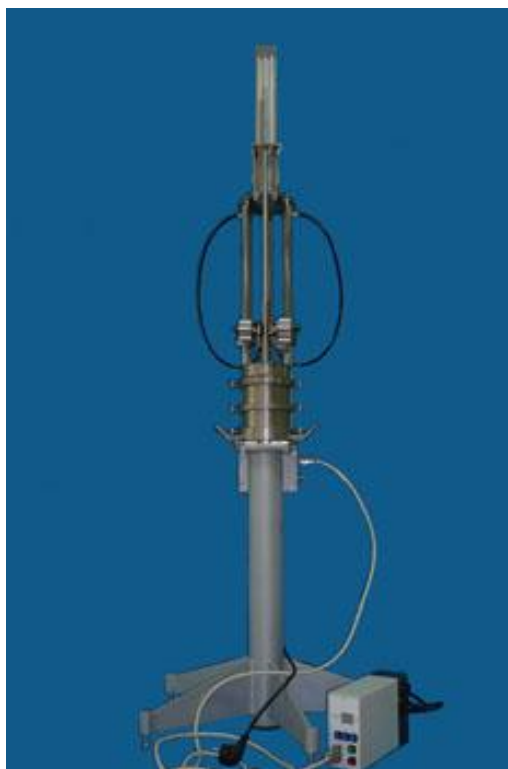
Рис. 1. Прибор стандартного уплотнения
