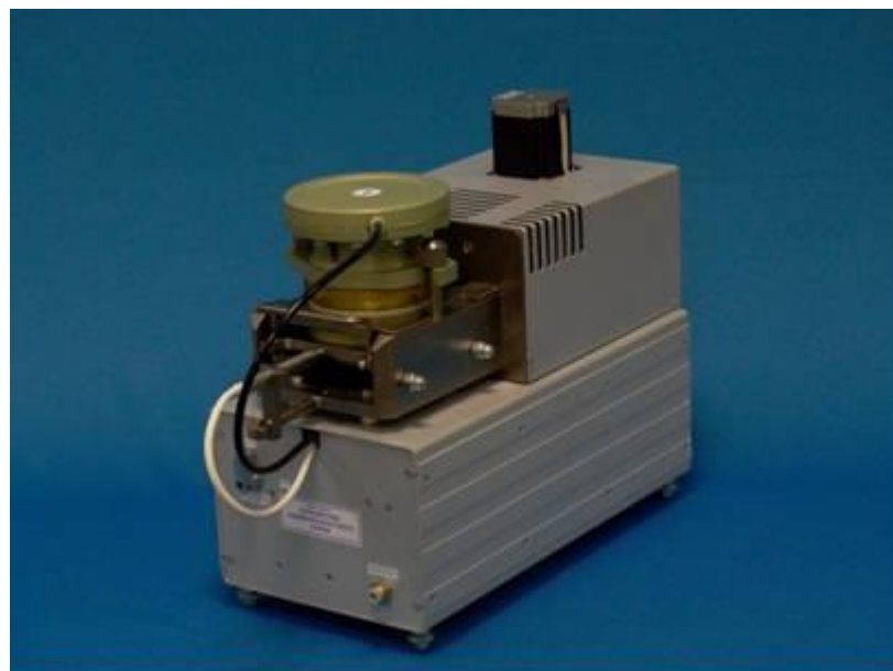
Рис. 4. Срезной прибор с кинематическим нагружением со скоростью деформации среза от 0,01 мм/мин до 5,0 мм/мин
