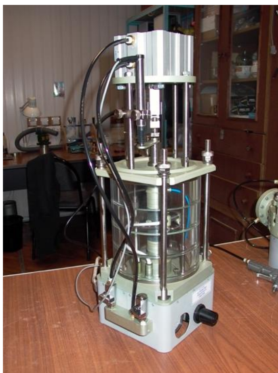
Рис. 5. Прибор трехосного сжатия типа А и Б
