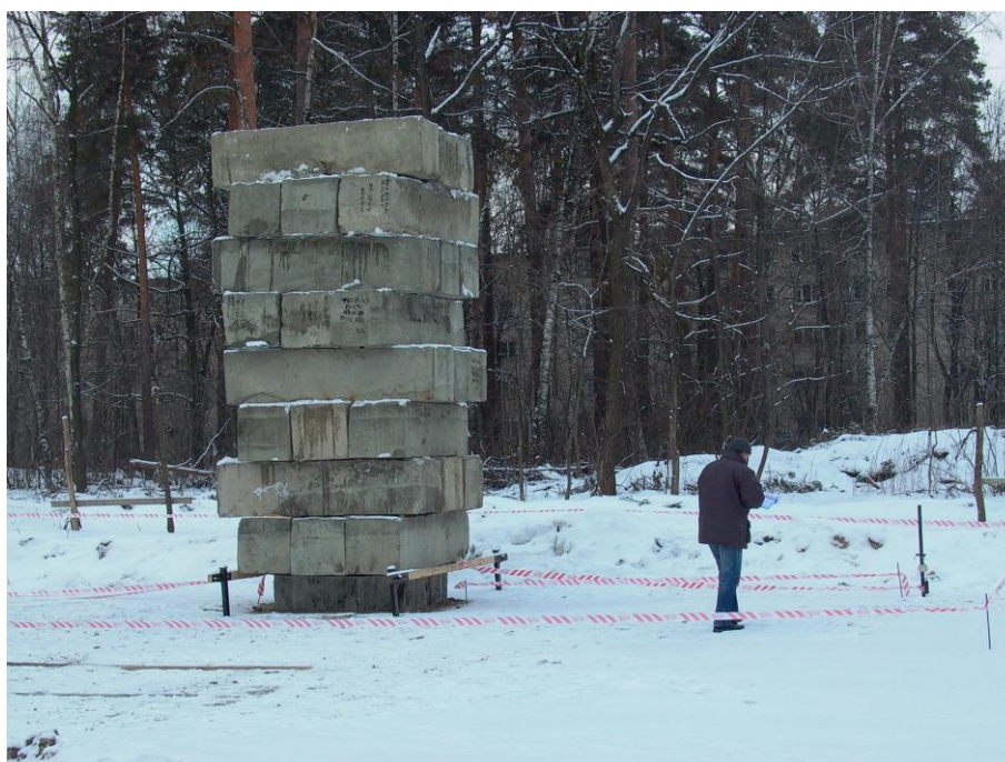
Рис. 8. Испытания грунта штампом площадью 25000 см 2
