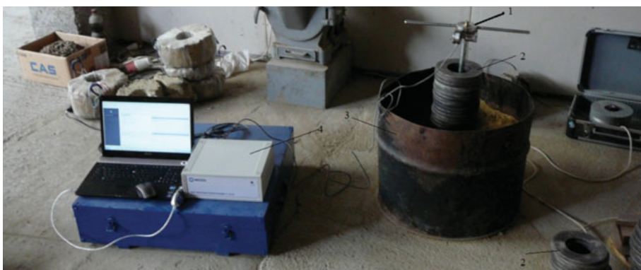
Рис. 5. Установка для испытаний с ручным режимом нагружения. Условные обозначения: 1 — устройство для создания крутящего момента; 2 — грузы; 3 — лоток с песчаным грунтом; 4 — измерительная система
