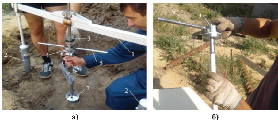
Рис. 6. Схема установки для комплексных испытаний грунтов: а — общий вид установки с кольцевым штампом; б — датчики силы для измерения вертикальной нагрузки и крутящего момента. Условные обозначения: 1 — складная упорная балка; 2 — анкера; 3 — датчик вертикальной нагрузки; 4 — датчик крутящего момента; 5 — ручки; 6 — штанга; 7 — кольцевой штамп
